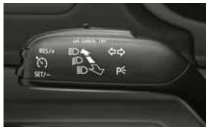
Farthållare för alla motorvarianter (5J1 035 623 för bilar utan dator on-board, 5J1 035 623A för bilar med dator on-board)
