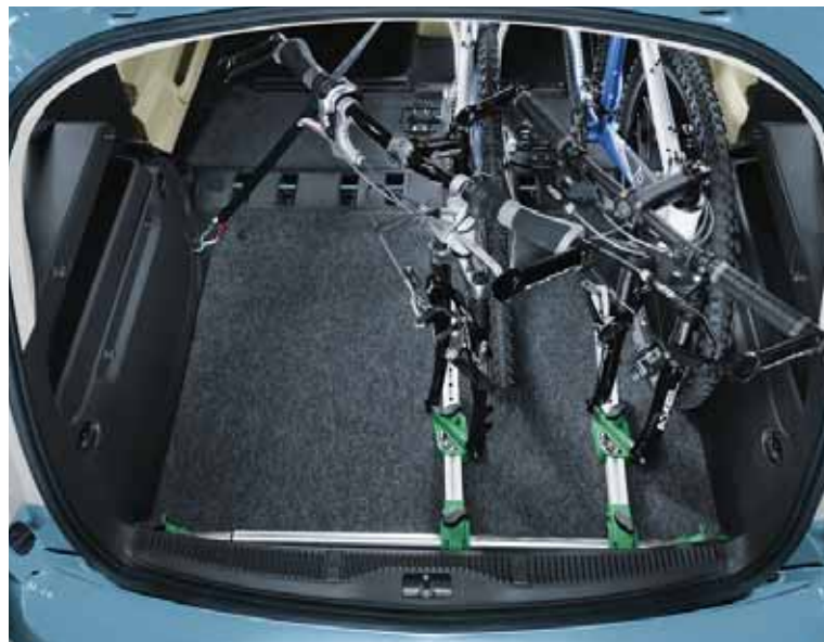
Cykelhållare, invändig montering lastar 2 cyklar (3T9 056 700)
