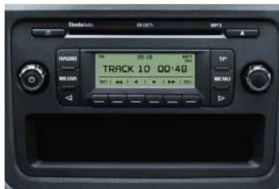
Radio Blues: CD spelare för ljud CD och MP3 ljudfiler, AM/FM tuner med RDS system, stöldskydd i form av elektronisk kryptering, amplifier power 4x 20 W (5J0 035 152A)
