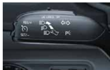
Farthållare för alla motorvarianter (5J1 035 623 för bilar utan dator on-board, 5J1 035 623A för bilar med dator on-board)
